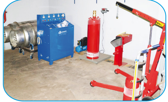
محطة تعبئة الغاز LPCB - FM200 filling station & systems
