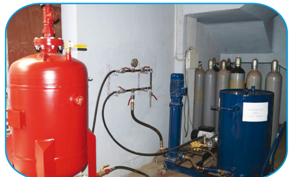
وحدة اختبار الضغط حتى 50 بار Hydrostatic pressure test station
